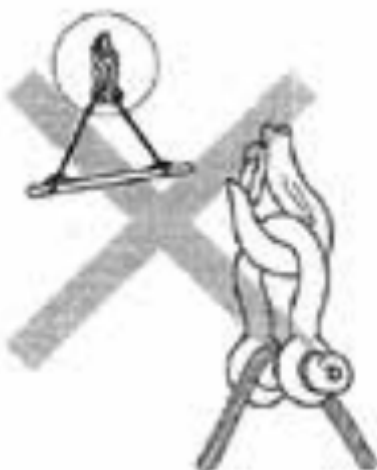
Figur 8: Feil rigging av sjakkel.
