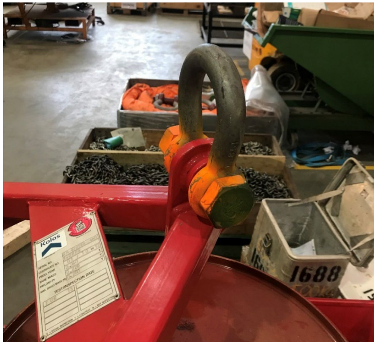
Figur 5 viser sjakkell korrekt montert. NB splint vises ikke på bilde.
