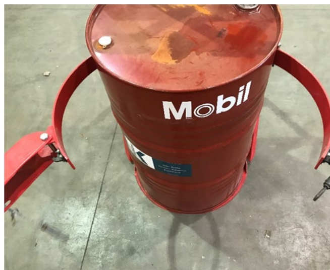
Figur 2 viser fat korrekt montert i fat-løfteren
