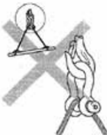
Figur 8: Feil rigging av sjakkel.
