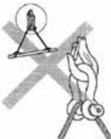
Figur 8: Feil rigging av sjakkel.
